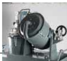
Spänebehälter einfache Entleerung durch Kurbel-Kippsystem
